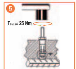
Montagedrehmoment T_{inst} = 25 \text{ Nm} mittels geeichtem Drehmomentschlüssel aufbringen.
