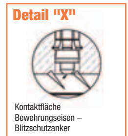
Montagedrehmoment T_{inst} = 25 \text{ Nm} mittels geeichtem Drehmomentschlüssel aufbringen.
