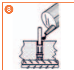
Ringspalt mit Injektionsmörtel vollständig auffüllen.
